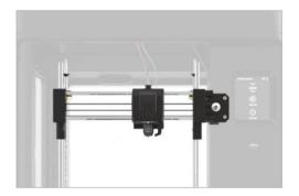
Die Vorrichtung, die es dem Wagen und den Extruderbaugruppen ermöglicht, sich in der X- und Z- Achse zu bewegen. (Die Bauplatte bewegt sich entlang der Y-Achse)
