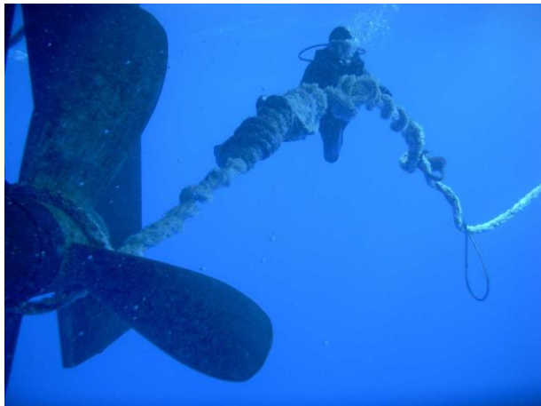
Ein im Meer treibendes Seil hat sich um einen Schiffspropeller gewickelt. (Foto: NOAA Marine Debris Program (NOAA OMAO)/ flickr.com / CC BY 2.0)
